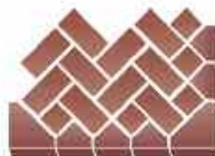
Verlegung mit Bischofsmützen
