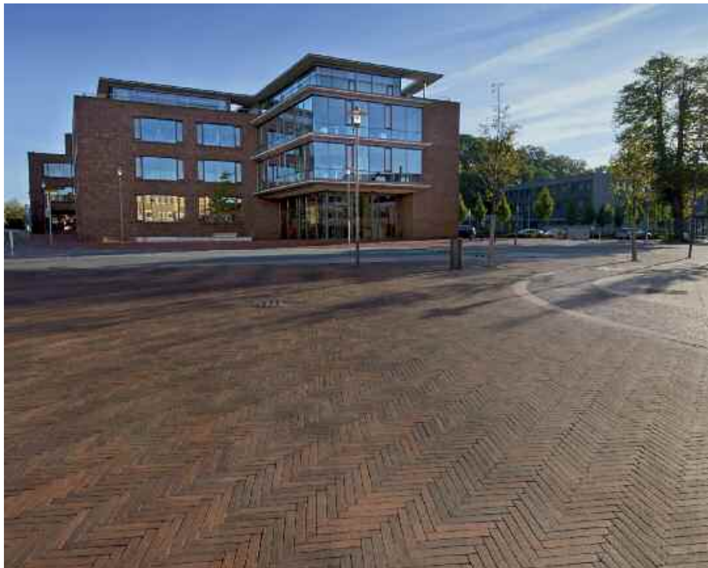
Malmö blau-bunt Schmolz, Langformat mit konischen Abstandhaltern
