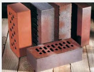
erhält. Der Massenanteil der Wasseraufnahme darf bei Klinkern höchstens 6 % betragen und die Druckfestigkeit muss mindestens der Klasse 28 entsprechen. Klinker müssen eine mittlere Scherbenrohddichte von mindestens  $1,9 \text{ kg/dm}^3$  aufweisen. Die Frostbeständigkeit muss durch Prüfung nachgewiesen sein.
