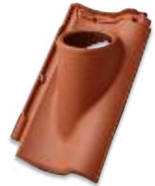
Thermenabgaselement/Grundplatte (100 + 125 mm Ø) in Verbindung mit Gummimanschette als Antennenziegel verwendbar
